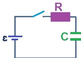
من اللحظة التي يتم فيها إغلاق القاطع بالدائرة، يتم شحن لوحات المكثف بنفس المقدار لكن بإشارة عكسية، حتى يصبح توتر المكثف مساوياً للقوة الكهربائية الدافعة للبطارية.
