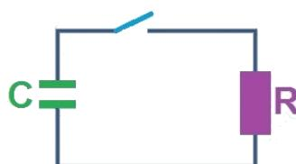
من اللحظة التي يغلق فيها قاطع الدائرة، تقل كمية الشحنة على كل لوحة، وينخفض التوتر بين أطراف المقاوم. **شدة التيار البدائية** - بمجرد إغلاق قاطع الدائرة، يكون التوتر الموجود على المقاوم مساوياً لتوتر المكثف البدائي، ومن الممكن التعبير عن شدة التيار البدائية، باستخدام قانون أوم على المقاوم، وفقاً للتوتر البدائي في المكثف  $U_0$ :
